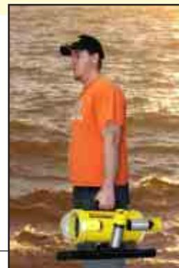
ROV水下机器人拥有一个强大而精密的马达推进系统，其中两个马达提供前进/后退动力，另两个马达提供垂直/横向动力。高输出功率的马达可以反转和变速。配备的PS2型控制手柄用来操作这个系统，一个操纵杆控制水平方向的马达（向前/后退和旋转），它可以“就地”悬停和360度旋转，另一个操纵杆控制垂直方向的马达（向上/向下和横向移动）。此外，也可使用无线的PS2控制手柄。当出现高水流速状况时，就需要更大的动力，控制手柄上的按钮可以将最大动力提高30%，大大地增加了推力。
