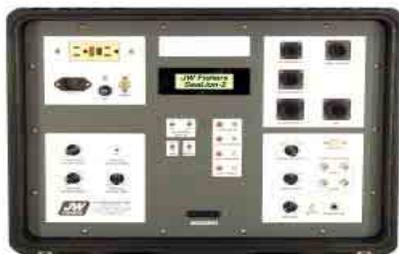
控制面板上开关、控制部件和接口连接器
